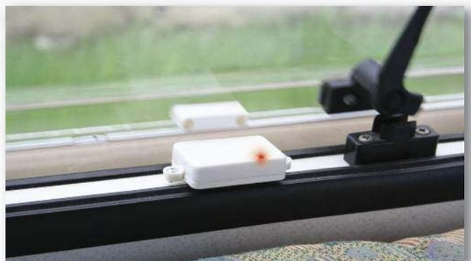
vier Funkmagnetkontakte enthalten. Wer mehr benötigt, kann die Anlage auf maximal acht ergänzen, was die meisten Angriffspunkte im Reisemobil abdeckt. Die Funkmagnetkontakte werden an Stauklappen, Standardfenstern und Aufbau Tür montiert und dann einmalig durch kurzes Öffnen des Schalters an der CamperAlarm-Zentrale angemeldet. Jeder Kontaktschalter bekommt dabei einen von zwölf Millionen möglichen Codes und behält diesen. Die Funkkon-
